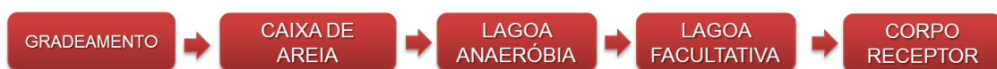
Figura 15. Fluxograma do processo de tratamento – ETE São Simão (existente). Fonte: Consórcio EY / CONEN / LACAZ MARTINS / ZIGUIA.
